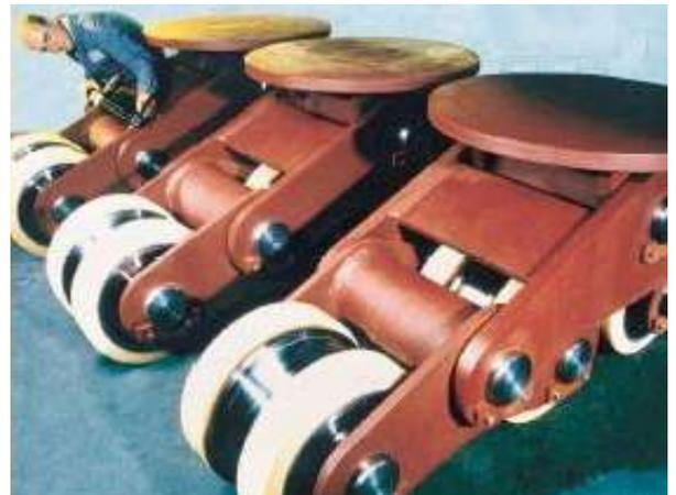
Rotantes pivotantes con pletina direccional. Formados por 4 ruedas de  $\varnothing 505\text{ mm}$ . de doble pestaña, con núcleo de acero y banda de Vulkollan® (antihidrólisis). Ejes de acero inoxidable girando sobre casquillos de bronce fosfatados.
