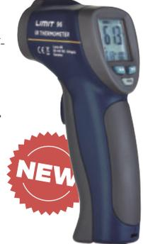
**DIGITAL IR (INFRARROJOS). Carcasa IP65** para poder utilizarla en un entorno de toba. Pantalla LCD con dígitos de 14 mm y retroiluminación. Puede medir tanto °C como °F. Batería tipo 9 V, incluida.
