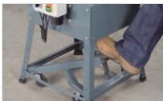
· El tren de ruedas de serie con dos guías/poleas permite un transporte sencilla. Para mover la máquina sólo hay que pisar las asas inferiores, de manera que las ruedas se coloquen abajo. Después, un muelle devuelve la estructura a la posición inicial.
