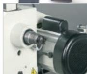
La velocidad se puede regular de forma cómoda y rápida mediante una palanca situada en el lado del operario.
