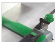
• El plano de hierro está cubierto por una protección con anclaje manual rápido. La eliminación de viruta requerida para el regrueso se ajusta fácilmente hasta 2 mm por manivela con una escala de fácil lectura. (figura muestra ADH 250).
