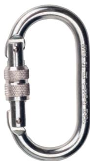
Mosquetón ovalado de acero con cierre roscado, longitud: 106mm, abertura: 19mm. Carga rotura: 25kN
